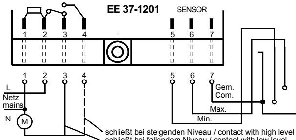
Die "Gem./Com." Elektrode kann mit einem metallischen Flüssigkeitsbehälter oder einer Rohrschlange verbunden sein. Bei leerem Behälter schaltet das Relais eine Pumpe, die erst abschaltet, wenn der Füllstand die Maximum-Elektrode erreicht hat. Die Pumpe startet erneut, wenn der Füllstand bis zur Minimum-Elektrode gesunken ist.
