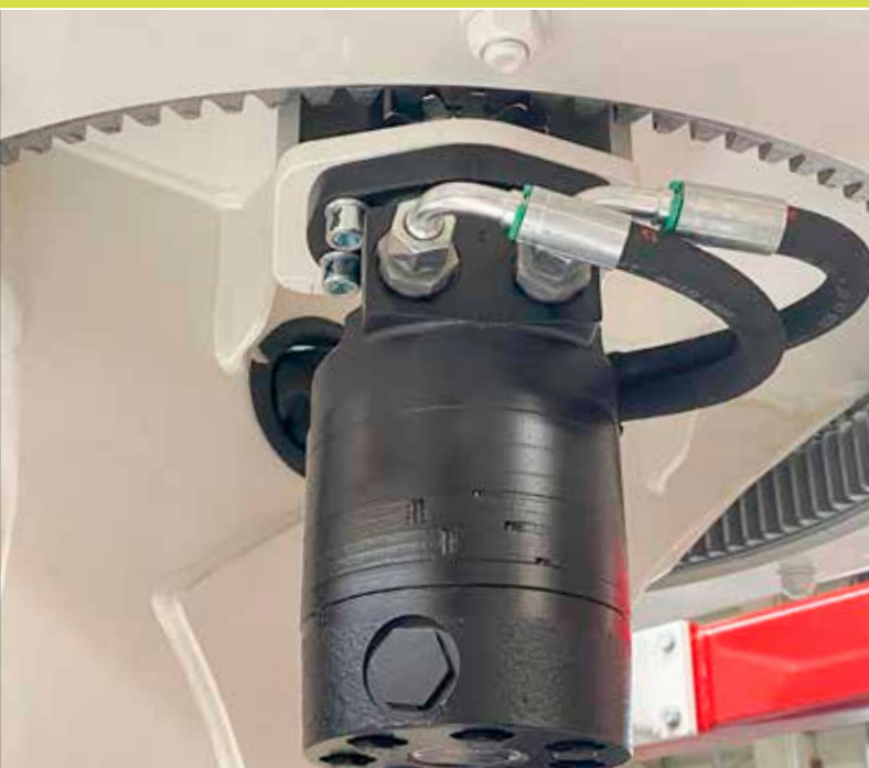
Moteur rotatif contrebalancé avec couronne rotative doublement vissée pour un travail plus précis !
