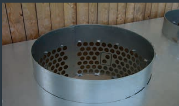
Système d'optimisation de la vitesse d'air pour un séchage uniforme des balles rondes.
