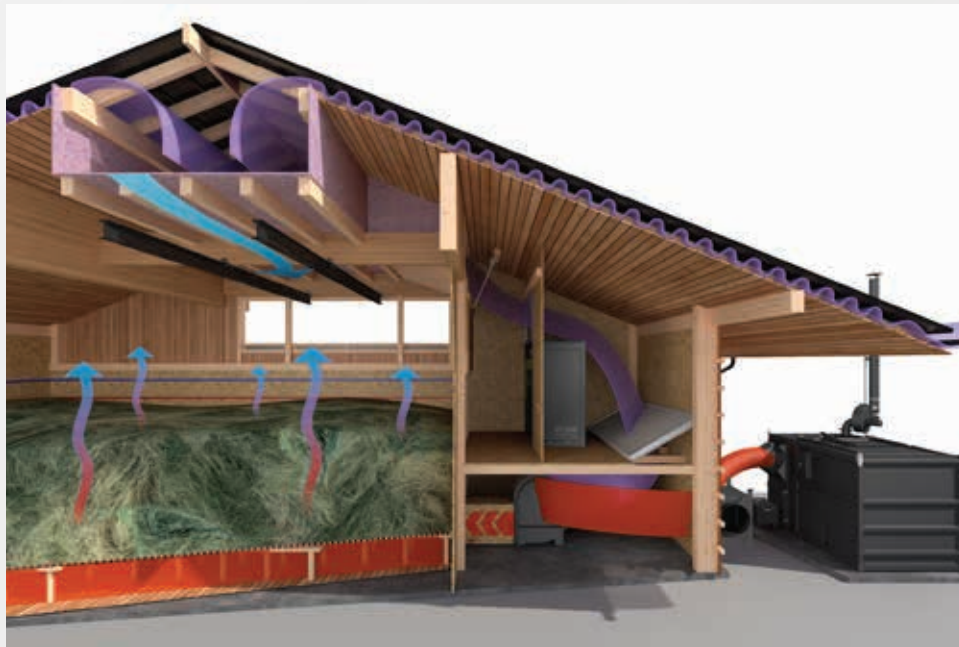
Séchoir avec générateur d'air chaud et récupération de chaleur en toiture.
