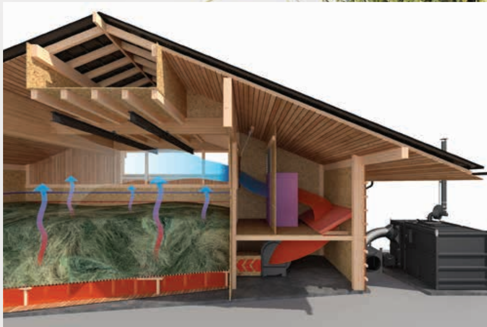
Séchoir avec déshumidificateur (registre en option) en circuit fermé.
