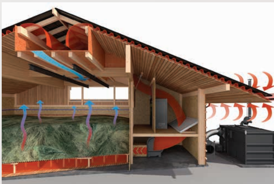
Séchoir avec récupération de chaleur en toiture.
