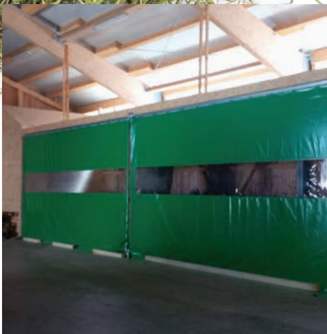
Séchage de balles rondes avec déshumidificateur d'air et rideau.
